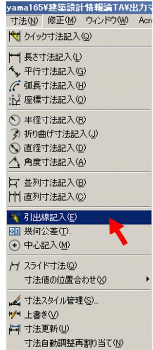
2) 引出線を配置する場所、テキストが終わる位置をクリックし、最後に右クリックする。右クリックするとテキストウインドウが現れるのでテキストを打ち込み(図d参照)、図cの「OK」ボタンを押す。
