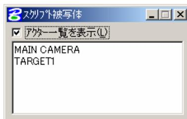
11 TARGET1 をスクリプトに追加するために、リストボックスの TARGET1 をダブルクリックします。
