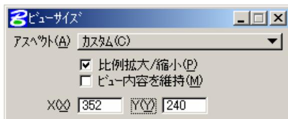
4 ビュー-8 でデータ点を入力し、ビューサイズダイアログボックスをアクティブにします。X320×Y240と入力します。
