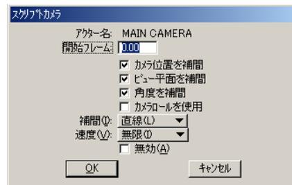
14 開始フレーム 0 と入力し、OK をクリックすると、スクリプトに追加されます。**MAINCAMERA** は、フレーム 0 で有効になります。アニメーションスクリプトは、完成しました。プレビューしましょう。
