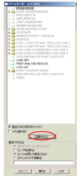
6 [解析/印刷コマンド][荷重リスト]ダイアログの>>をクリックし、全ての荷重ケースを選択し、[追加]をクリック。
